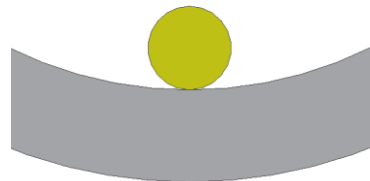
Figur 6-5: Kabel i et 8 tommers rør.
