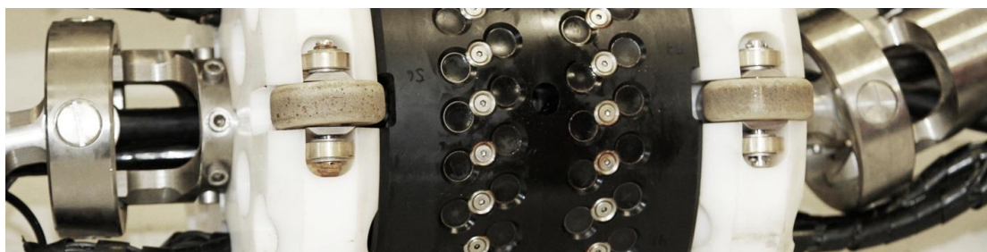
Figur 3-5: På bilde ser vi prøberingen til PipeScan (OSAIN).
