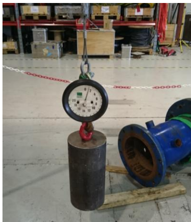
Figur 5-4: 110 kg last og vekt (MSS).
