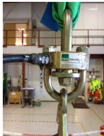
Figur 5-3: Sensor over trinse nummer 2 (MSS).
