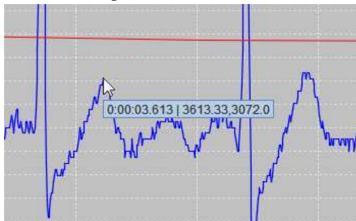
Figur 24: Det er mulig å lese koordinatens data ved å holde musepekeren over punktet. En tooltip-verdi er delt opp i forløpt tid (i Timer:Minutter:Sekunder.Millisekunder -format) og (X,Y)-data.
