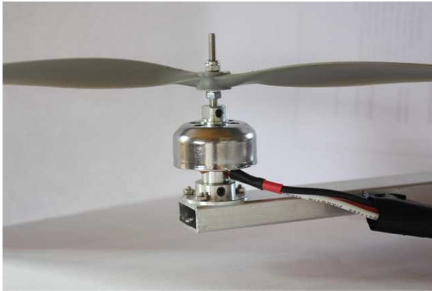
Figur 3.5: Bilde viser hvordan motoren ble montert.
