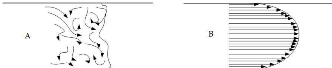
Figur 3.2: A - Turbulent strømning, B - Laminær strømning.
