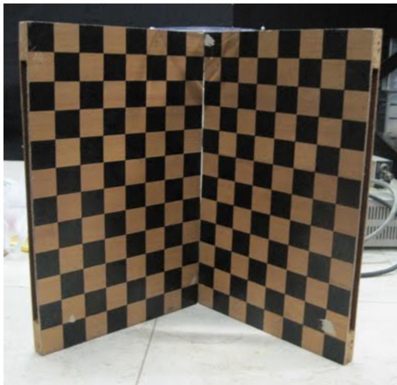
Figur 5: Viser et 3-dimensjonalt kalibreringsobjekt bestående av to plan vinkelrett på hverandre. Planene kalles ofte "Tsai grid".
