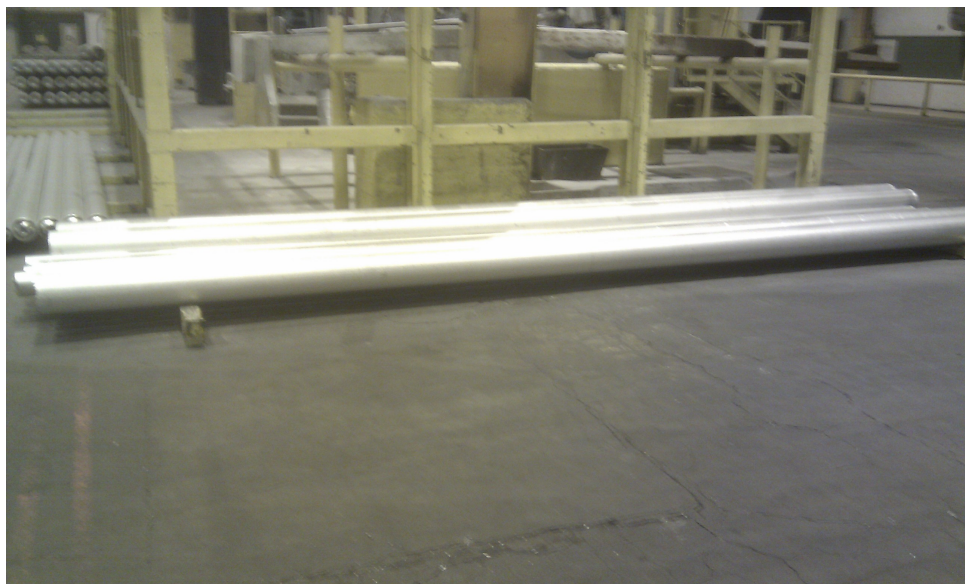
Figur B.6: Bolt oppbevart på gulvet klare til omsmelt
