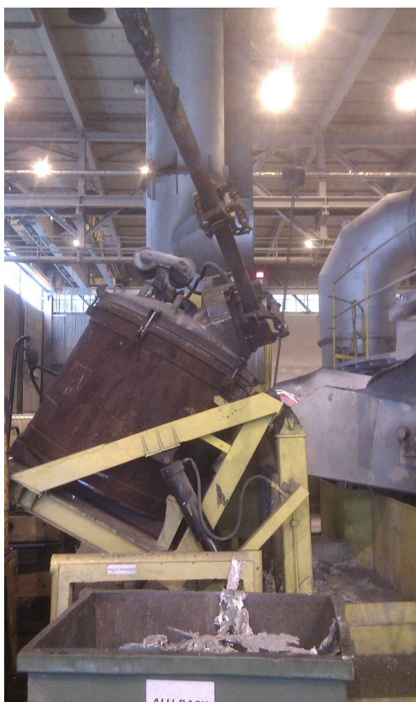
Figur B.5: Digle med elektrolysemetall som tømmes i ovn 6
