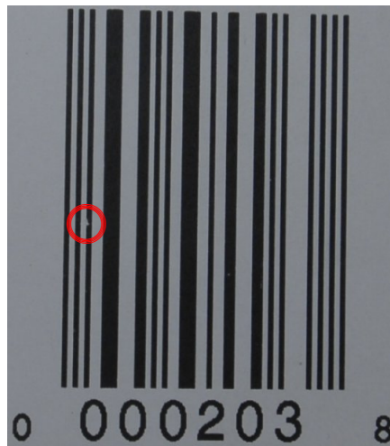
Figur 5.5: Deteksjon av én strekkode per bilde - Eksempel på mislykket dekoding, rusk på strekkoden.
