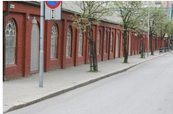
Amfi Vågen. Tette fasader, smale fortau hvor allé trærne gjør det vanskelig for orienterings- og bevegelseshemmede, og for de med barnevogn.
