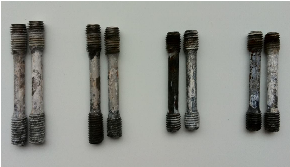
Figur 3.3 Bildet viser boltene etter 6 uker under katodisk beskyttelse. Fra venstre ligger 2 stk. ASTM A 453 Gr. 660, 2 stk. ASTM A 320 B8M, 2 stk. ASTM A 320 L7M og helt til høyre ligger 2 stk. ASTM A 320 L7.
