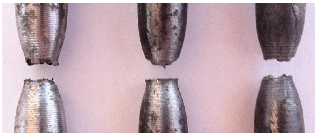
Figur 3.13 Bruddet til referansebolten (venstre) og forsøksboltene (midten og høyre) av type ASTM A 320 L7M.
