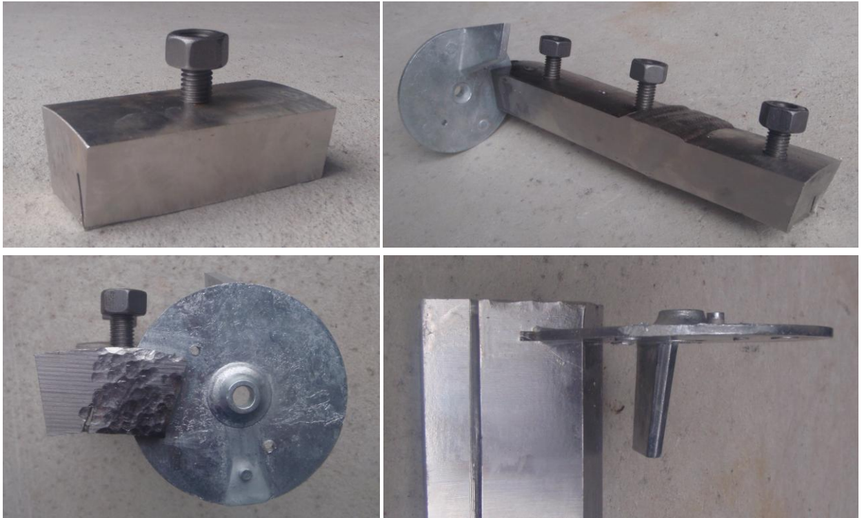
Figur 2.6 Bildene viser bar med karbonstål bolt (oppe til venstre), bar med karbonstålbolter som er katodisk beskyttet (oppe til høyre) og detaljer hvordan anoden ble festet (nede). Sinkanoden ble plassert i et utskjært snitt i baren. Deretter ble det hamret hardt på området rundt slik at den kilet seg fast. Det ble smørt epoxy rundt området der anoden ble festet for å opprettholde den galvaniske kontakten mellom de to metallene.
