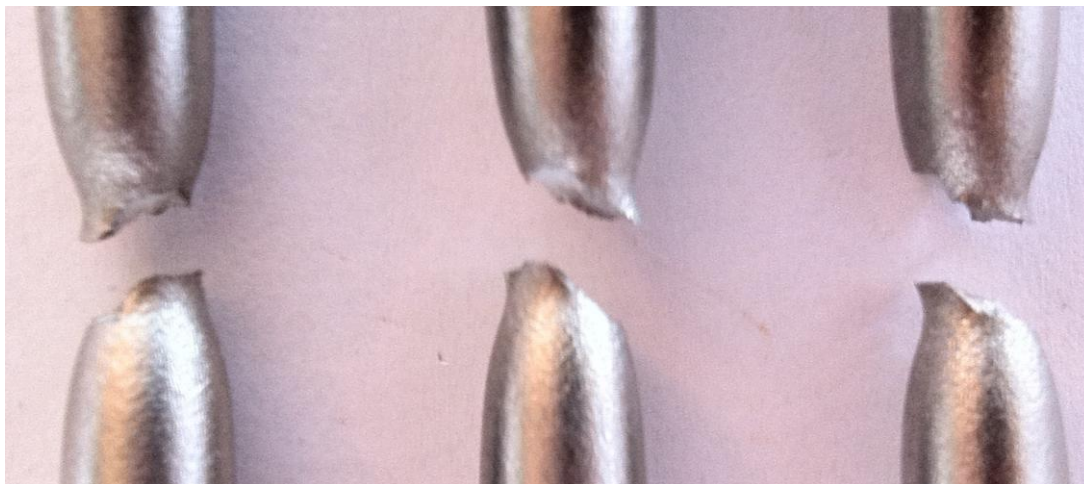
Figur 3.14 Bruddet til referansebolten (til venstre) og forsøksboltene (midten og høyre) av type ASTM A 320 B8M.
