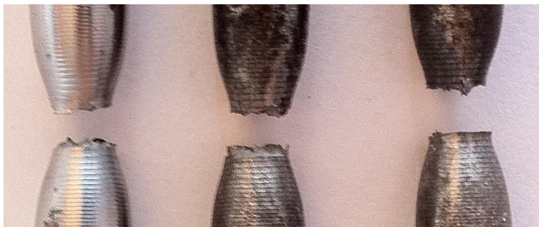
Figur 3.12 Bruddet til referansebolten (til venstre) og forsøksboltene (midten og høyre) av type ASTM A 320 L7.
