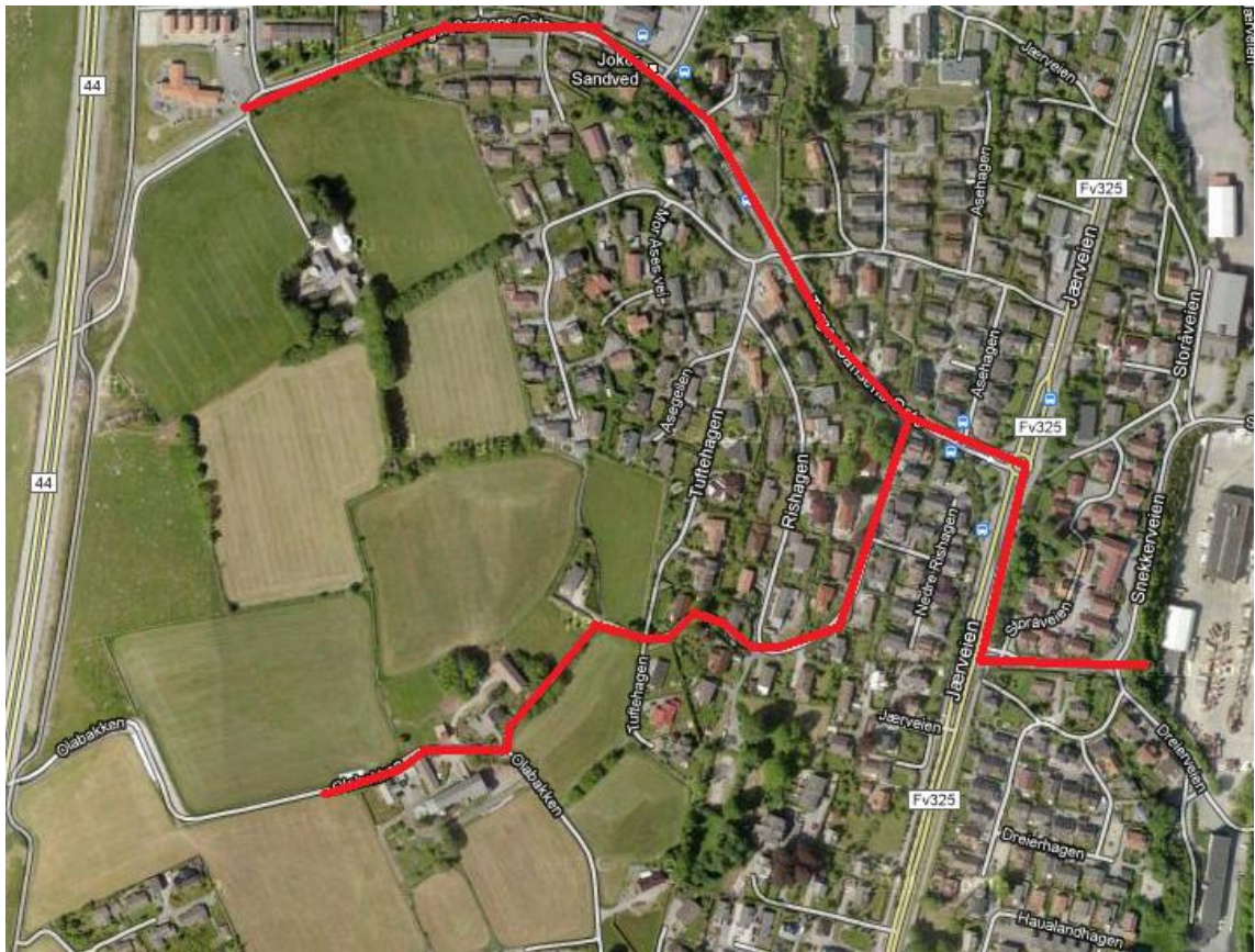
Figur 16: Naturlig trasé for ny overvannsledning (maps.google.com)
