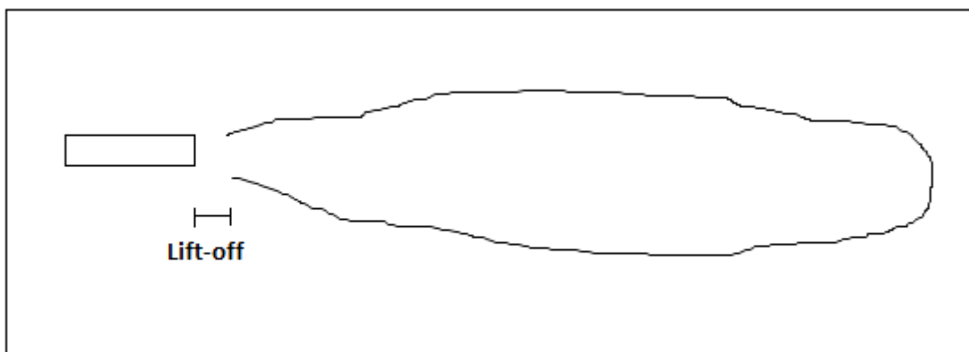
Figur 3 Figuren viser en jetbrann med lift-off.
