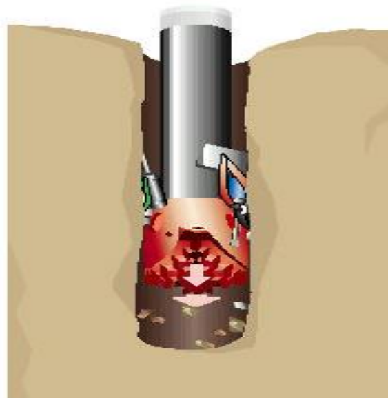
Figur 3-21. Her ser vi falne deler eller utstyr som har falt av selv borings utstyret, bildet viser at det hindrer borekronen å bevege seg [5].
