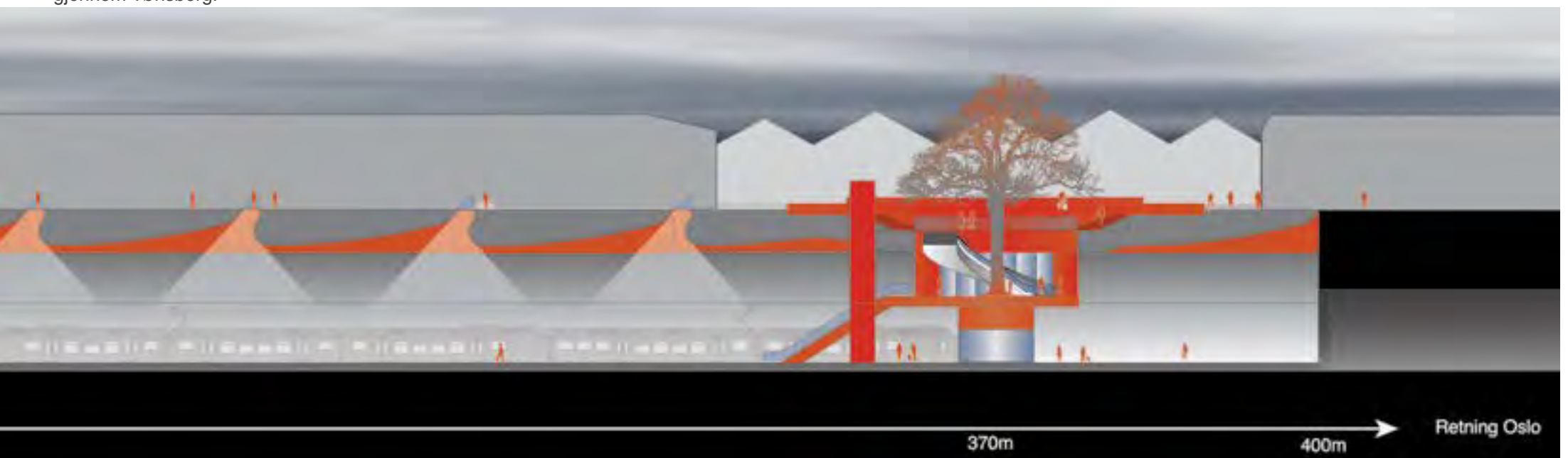
Lengdesnitt (1:500) av stasjonen i 400m-konfigurasjon, med mål som angir plattformlengde fra syd-enden. Det viste toget er en dobbel type BM 74, som i dag brukes i regiontog gjennom Tønsberg.
