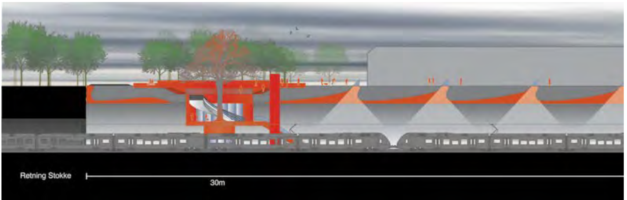
Lengdesnitt (1:500) av stasjonen i 400m-konfigurasjon, med mål som angir plattformlengde fra syd-enden. Det viste toget er en dobbel type BM 74, som i dag brukes i regiontog gjennom Tønsberg.
