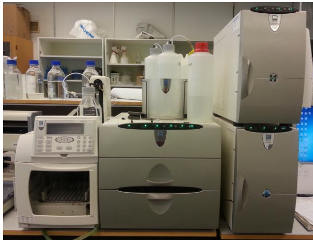
Fig. 3.9. A Dionex ICS-3000 Ion Chromatograph
