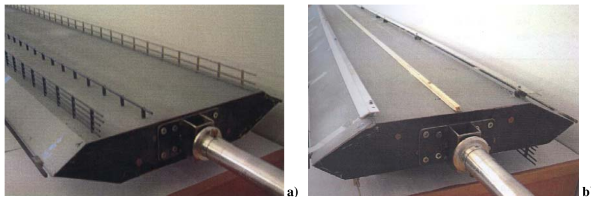
Figur 5-1: Bilder av broseksjonsmodellen som ble brukt ved vindtunnelforsøkene for Hardangerbrua, tatt ovenfra (a) og fra undersiden (b). Bildene er hentet fra vindtunnelrapporten [14]. Modellen er 1,7 meter lang og er laget i skala 1:50. Legg merke til at alle detaljer er tatt med i modellen, slik som rekkverk, ledeskovler og skinner for vedlikehold.
