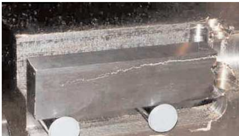
Figur 2.8.5 Sprekk forårsaket av clinking. 16
