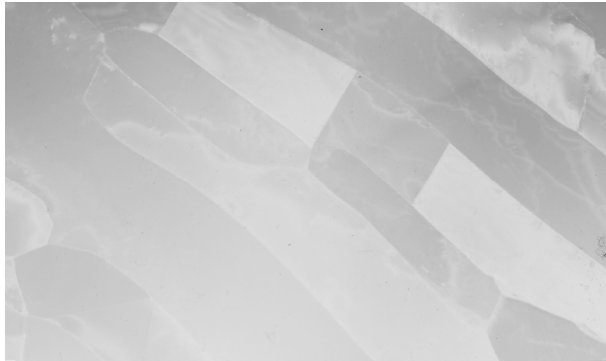
Figur 4.8.1 Lysfelt bilde av mikrostrukturen før varmebehandling
