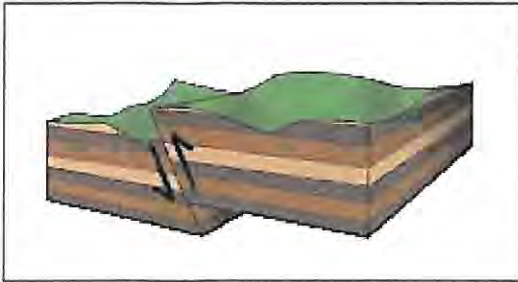
Figur 8, Reversforkastning. Flatene er i trykk, og de to delene støter mot hverandre [10].
