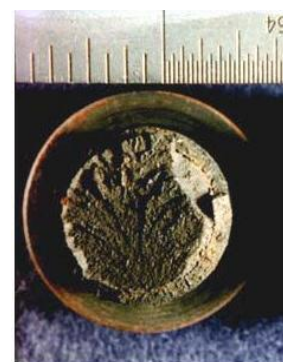
Figur 34: Brudd i bolt som følge av hydrogensprøhet. Kilde: The Hendrix Group
