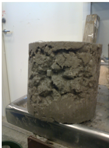
Figur 36: Ufullstendig stamping av betong.
