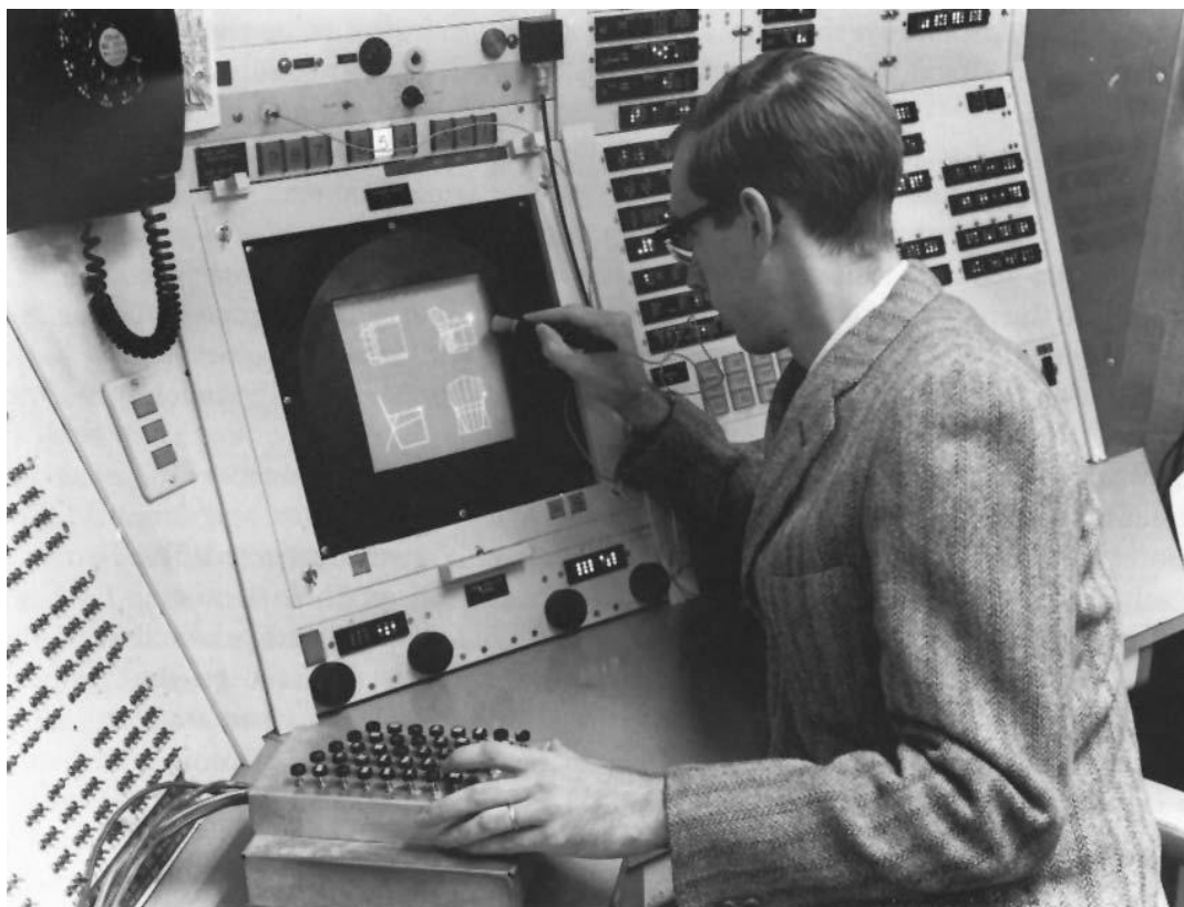
Figur 1-1: Sketchpad i bruk av Ivan Sutherland. Programmet får input og kommandoer fra brukeren via en spesiell penn og et panel med en rekke knapper.
