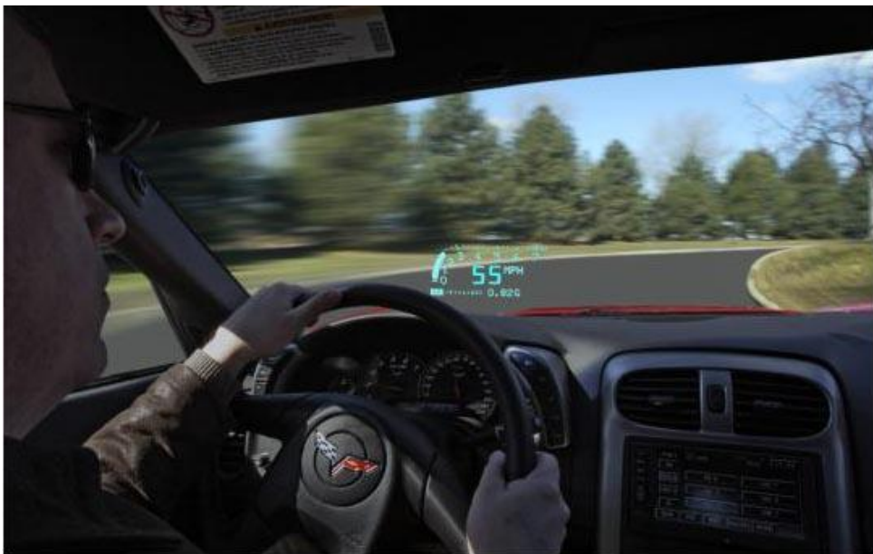
Figur 2-5: Eksempel på bruk av Head-up display i en bil. Sjåføren kan holde øynene på veien samtidig som han kan se nødvendig informasjon som blant annet bilens hastighet og turtall.
