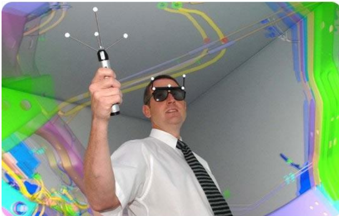
Figur 6-4: Briller som er nødvendig for å utnytte 3D-effekten og en spesiell stav som kreves for å kunne bruke flere av funksjonene i et CAVE-system.
