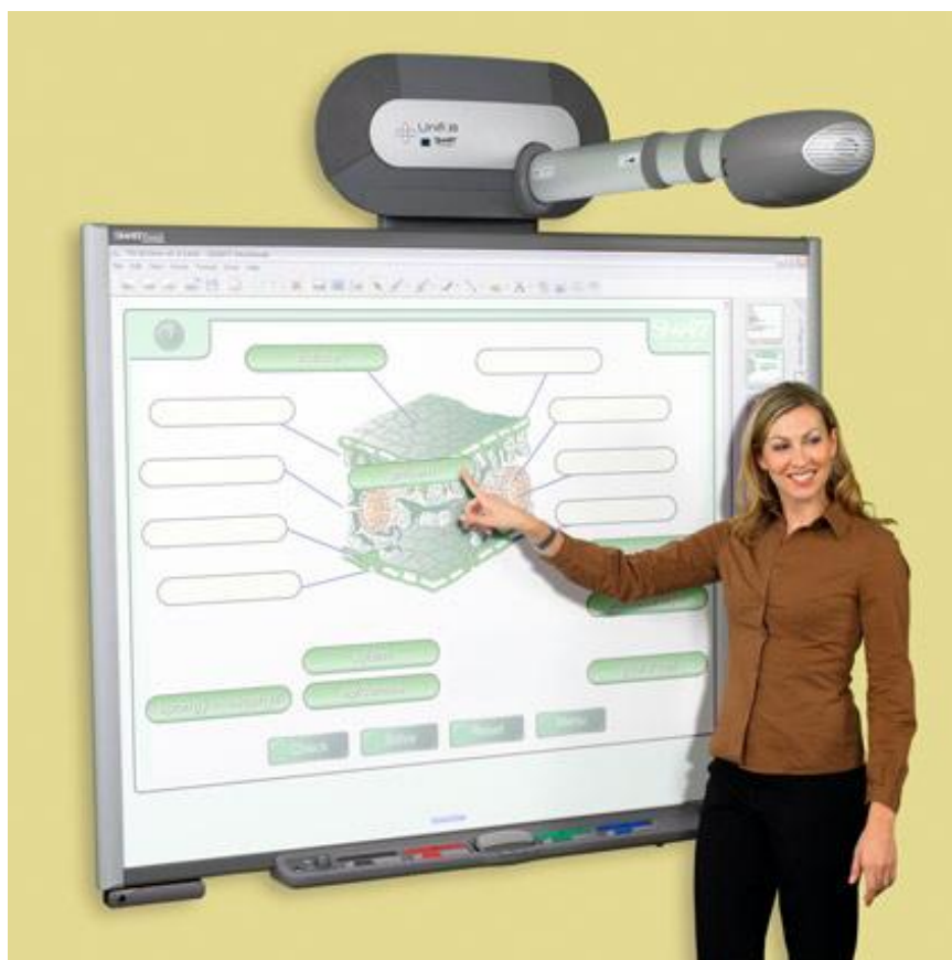
Figur 2-9: En variant av et smartboard. Projektoren er festet høyt og relativt nært lerretet for å unngå at brukeren kaster skygge på lerretet. Lerretet fungerer som en dataskjerm, et whiteboard og en touch screen.
