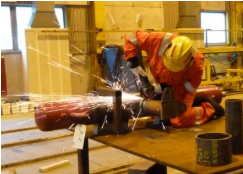
Figur 6-14 Pussing av overflate
