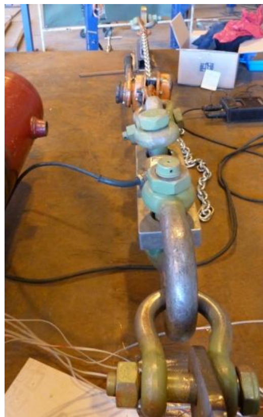
Figur 6-8 Testrig for langsgående bøyekrefter
