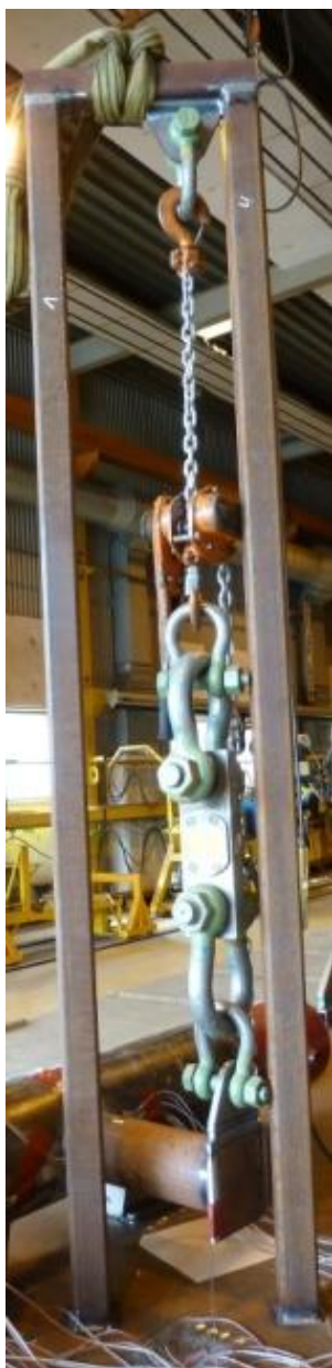
Figur 6-7 Testrig for tversgående krefter
