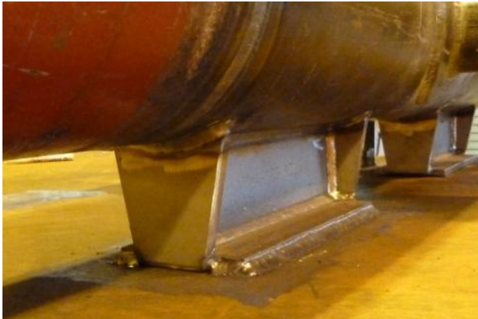
Figur 6-2 Sveisesko fastsveist til bordplaten
