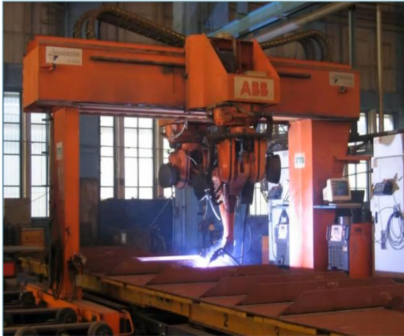
Figur 5.0: Automatisert maskinsveising av plater (hentet fra Internett)
