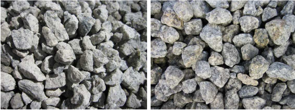
Figur 29: 8-11mm til venstre og 11-16mm til høyre
