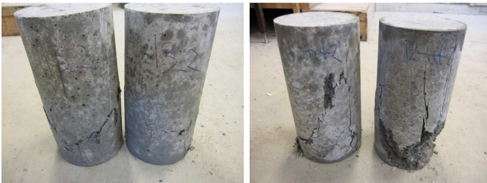
Figur 40: Sylinder trykkfasthet for 13_2 til venstre og 12-ref-2 til høyre
