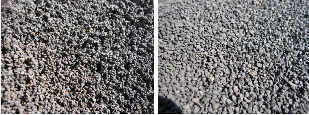
Figur 26: 0,8-1,5mm til venstre og 1,5-2,5mm til høyre
