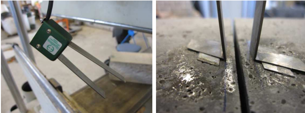
Figur 50: Til venstre displacement transducer(Clip Gauge) og til høyre festeanretning på bjelke med Clip Gauge
