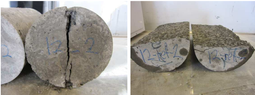
Figur 42: Spaltestrekkprøve for 12_2 til venstre og 12-ref-2 til høyre
