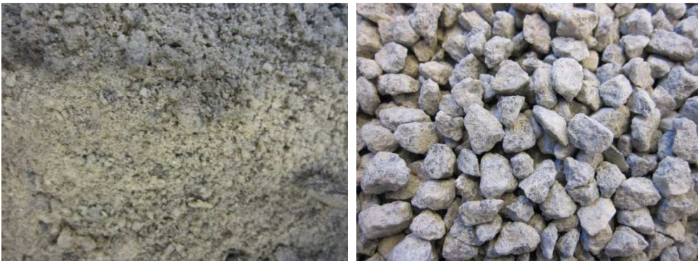
Figur 28: 0-5mm til venstre og 5-8mm til høyre
