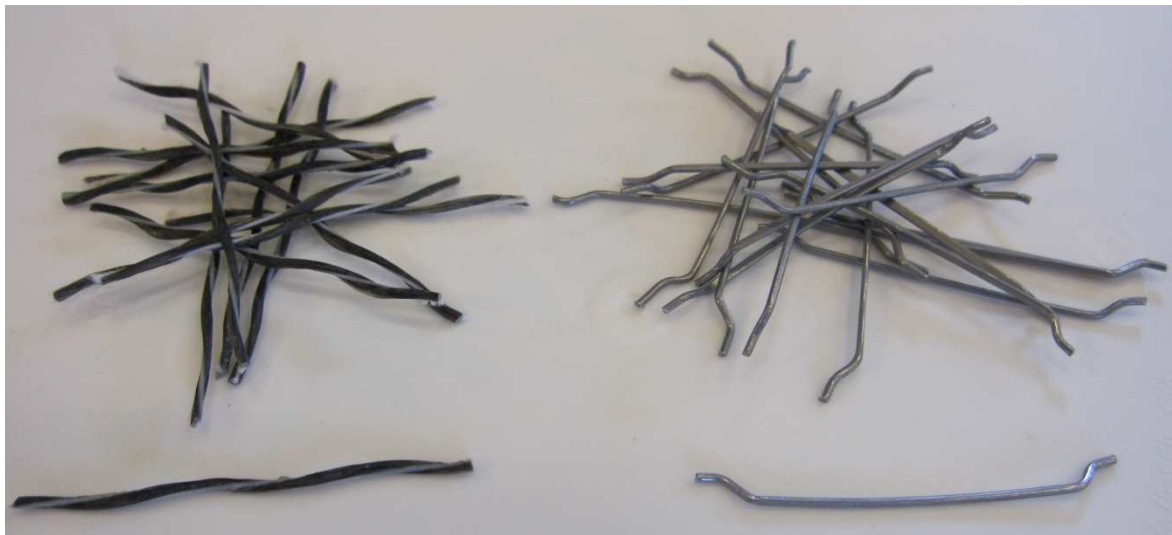
Figur 30: Basaltfiber til venstre og stålfiber til høyre
