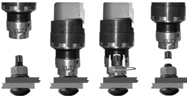
Figur 12: Prinsipp ved tiltrekking av HRC-bolt
