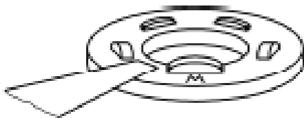
Figur 4: Kontroll av klaring ved bruk av DTI
