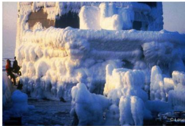
Fig. 10 Icing on K/V Nordapp, 27.02.1987 (Source: Loset,1999)
