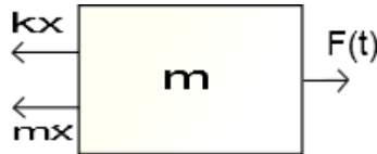
Figur 2.7: «Free-body diagram» for ett udempet system med tvungen vibrasjon og en frihetsgrad
