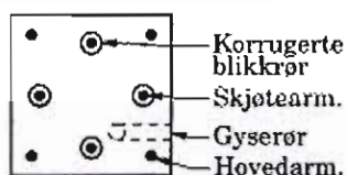
Figur 4-11 Plassering av korr. rør i et søyleverrsnitt
