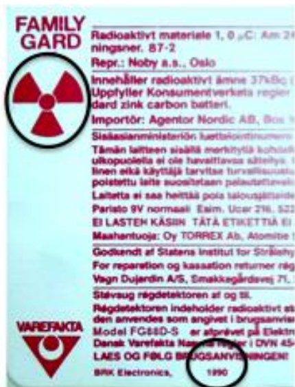
Figur 10. Baksiden av en ionisk røykvarsler fra 1990. Sort sirkel indikerer symbol for ioniske røykvarslere og røykvarslers produksjonsår (Kai Arne Jenssen, 2013).
