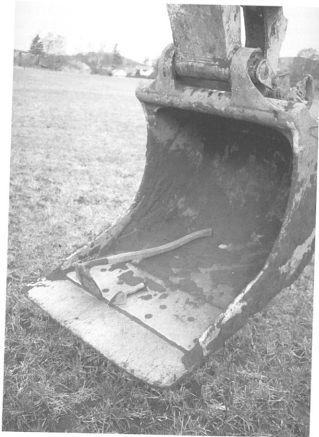
6. Anleggsskuffe med påsveiset stålskjær på norsk Brøyt beltegående gravemaskin. Foto: Olle H. Hemdorff, AmS.
