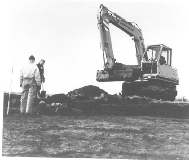
7. Gravemaskin med rabattskuffe, fra Vorbasse, Jylland. Foto: Steen Hvass.
