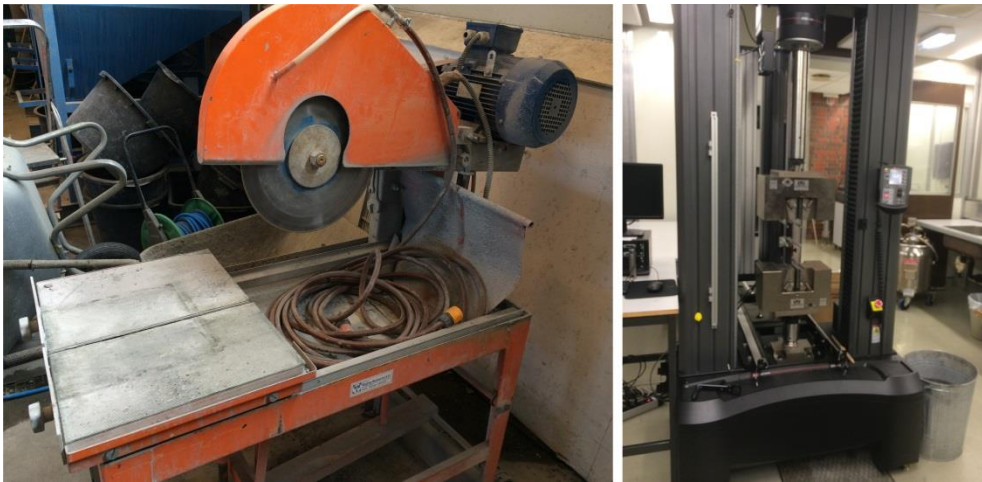
Figur 31: Til venstre: Betongsag. Til høyre: Strekkmaskin.
