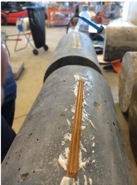
Figur 25: Sylindere med pålimte strekkklapper.
