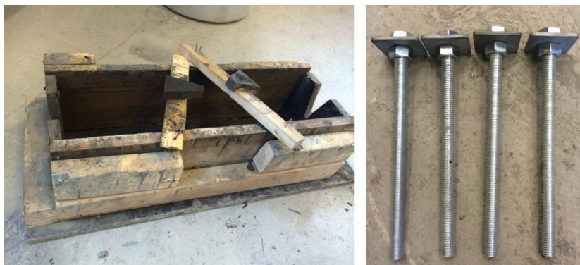
Figur 19: Til venstre: støpeform for bjelker til strekktesting. Til høyre: forankringsbolter.
