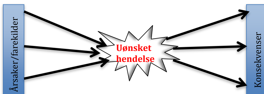
Figur 4: Risikoanalysene sine tre trinn som et ”bow-tie-diagram”, basert på Aven (2007)
