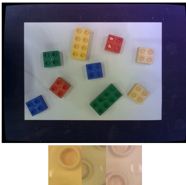
Figur 33: Fargeforskjell i forhold til distanse fra sentrum i bildet. De gule klossene i venstre til bildet har en annen farge enn klossen i midten. Under er klossene vist ved siden av hverandre.
