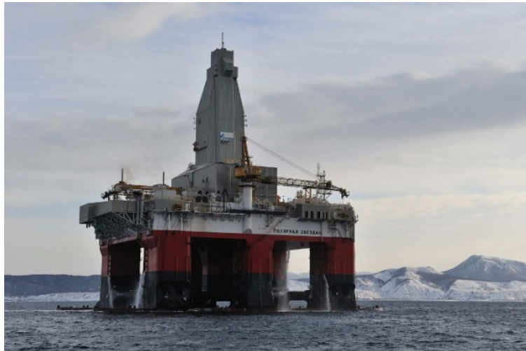
Figure 4.2: Semi-submersible rig (Staalesen, A., 2013)
