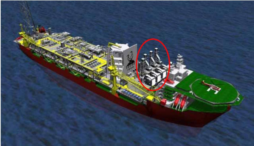
Figur 4-1: De fire generatorpakkene ombord på Skarv FPSO
