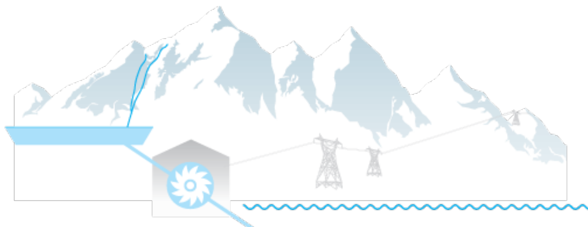
Figur 1: Skissert vannkraftverk med vannmagasin og utløp. Kilde: http://www.hydro.com/no/Hydro-i-Norge/Var-virksomhet/Vannkraft/Fra-vann-til-energi/ (Hydro, 2013)
