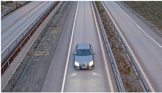
(a) Filming av kjøretøy kl 22.30 med Axis Q1615-E nettverkskamera. WDR funksjon er slått av.
