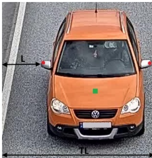
Figur 4.7 Fjerning av skygge: De to røde prikker er hjørnene som ligger nærmest høyre og venstre bilderamme. Grønn firkant viser til massesenteret . Lengde L avgjør hvor mye av bildet som skal kuttes. I oppgaven har en valgt å kutte 0.7*L for å unngå tilfeller der deler av sidelyktene blir feilaktig kuttet.
