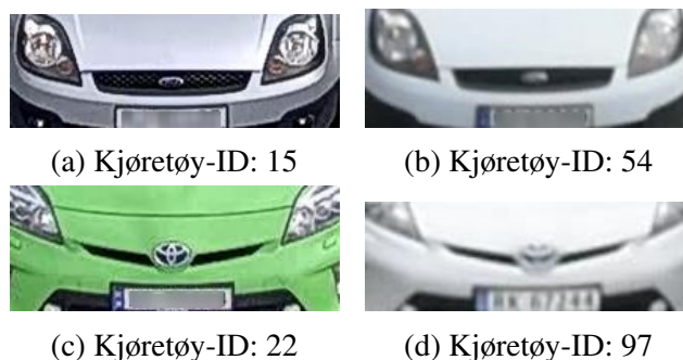
Figur 5.27 Frontutsnitt som gir feil ved matching av HOG deskriptor. Kjøretøy-ID 15 blir feilaktig matchet med Kjøretøy-ID 54 der den ene bilen er sølv og den andre er hvit. Kjøretøy-ID 22 blir feilaktig matchet med ID 97
