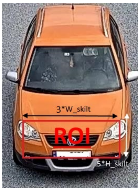
Figur 4.16 Definisjon av bilfront (roi) basert på posisjon av bilskiltet.
