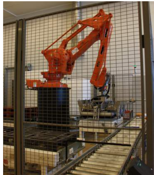
Figur 12: Roboten som legger ostene i kasser
