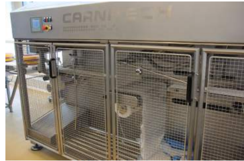
Figur 5: Posemaskinen, som legger osten i poser
