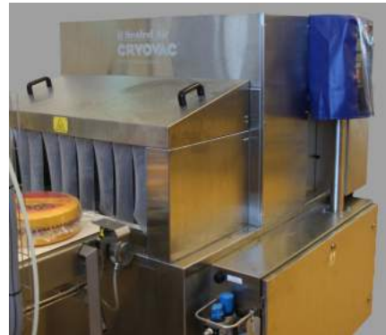
Figur 7: Maskinen med vannbadet
