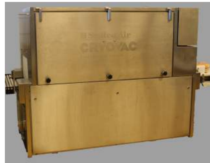
Figur 8: Maskinen som tørker osten
