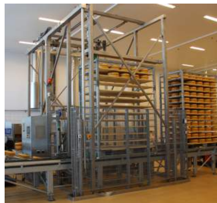
Figur 3: Destableren, som løfter ostene ut av stativene
