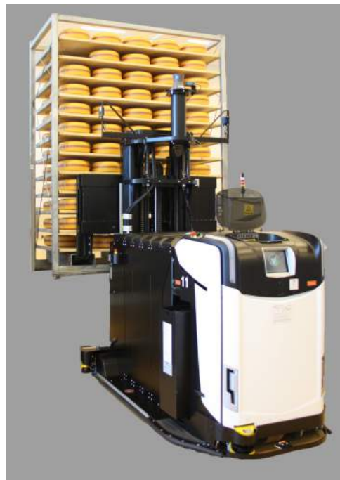
Figur 2: Automatisk guidet truck som leverer stativ
