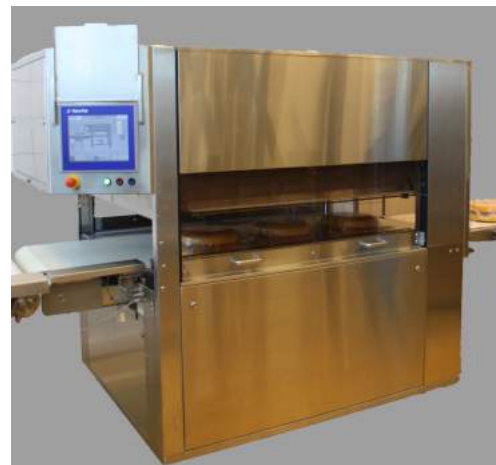
Figur 6: Vakuumpakkeren, som vakuumerer posene rundt osten
