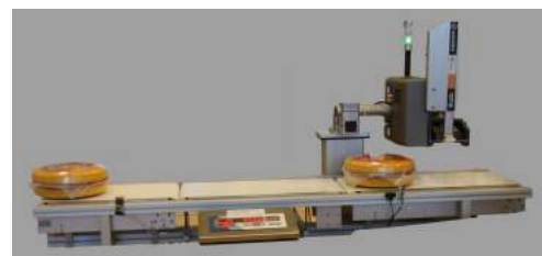
Figur 9: Vekten i midten og etikettmaskinen til høyre
