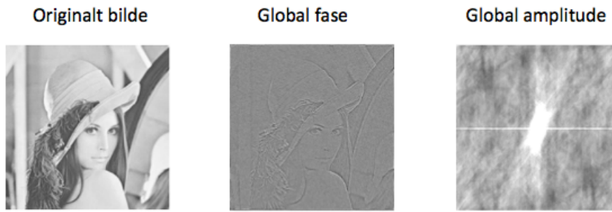
Figur 2.1: Originalt bilde til venstre, rekonstruert bilde fra global fase i midten, og rekonsturent bilde fra global amplitude til høyre
