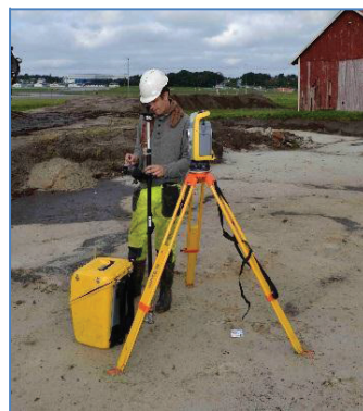
Figur 6. Innmåling ved hjelp av totalstasjon.
