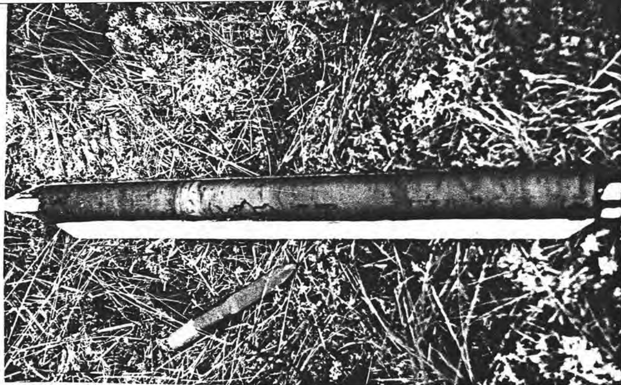
Sedimentkjerne tatt med russerbor, 75 cm lang, 5 cm diameter. (Foto:Hanne Thomsen)
