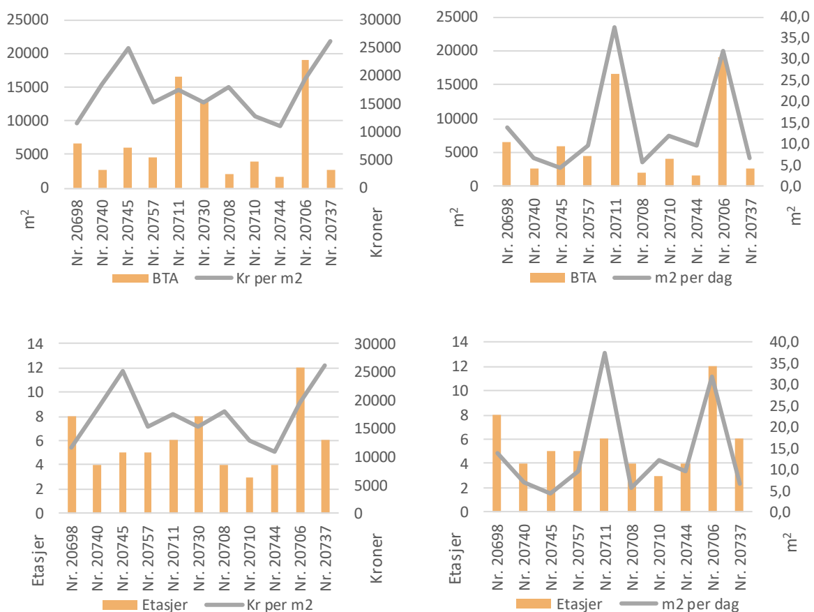
Figur 22 Sammenligning størrelse og antall etasjer med kostnads- og tidsbruk
