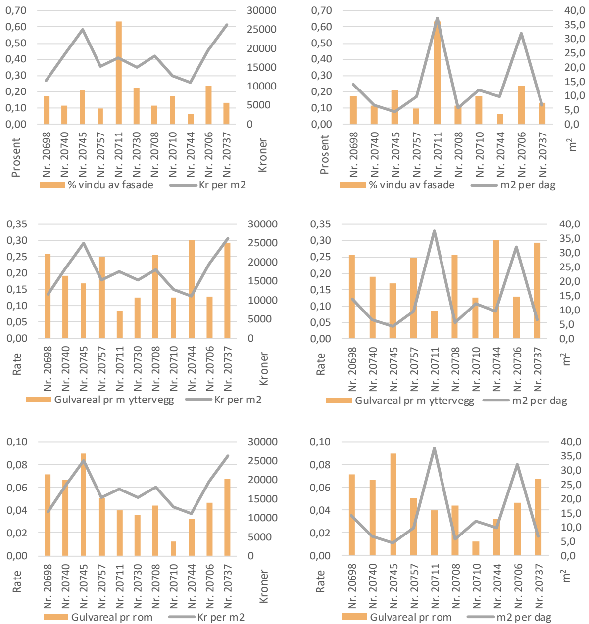
Figur 19 Sammenligning mellom ratene og kostnad- og tidsbruk
