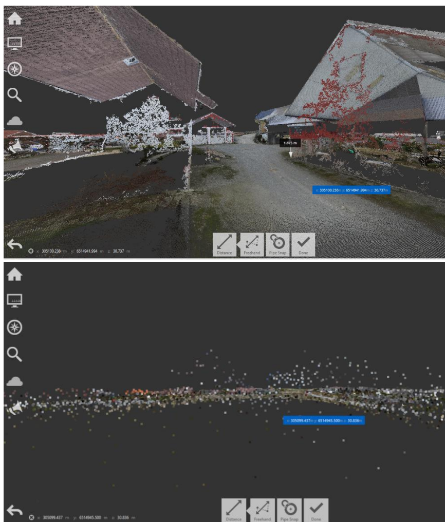
Figur 5.21 Eksempler på detaljer i fullskalamodellen (over) og bilde tatt fra tilsvarende steder i den simplifiserte modell (under). I fullskalamodellen kan detaljer på gårdsplassen sees, men i den spesifiserte modellen er det lite som viser at punktskyen er fra en gårdsplass.
