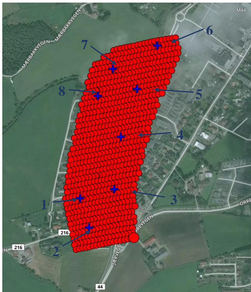
Figur 5.10 Bilde over Reemarka. Røde punkter er bildene som er tatt, og blå kryss er kontrollpunkter/GCP. Dronen tar bilder utenfor plangrensen (se figur 5.1) for å sikre maksimal mengde overlapp av bilder også på grensene.
