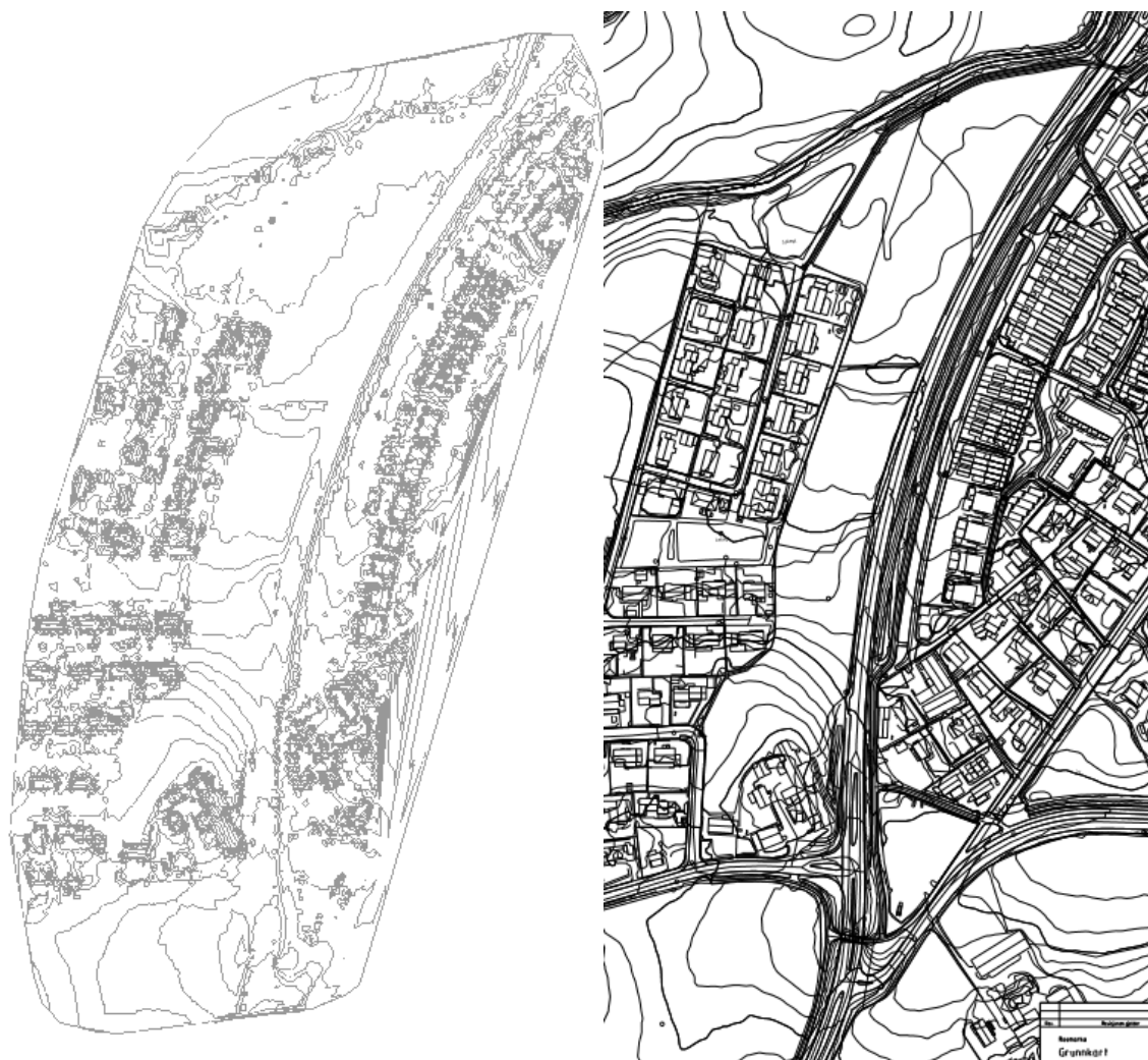
Figur 5.26 Sammenligning av den digitale terrengmodellen i Revit og kartgrunnlaget fra manuell landmåling (Gjengitt med tillatelse fra Prosjekttil, 2017). Kotene er sammenfallende, men det kan sees at det i modellen fra manuell måling er rettere linjer, og tilsynelatende færre punkter langs kotene.
