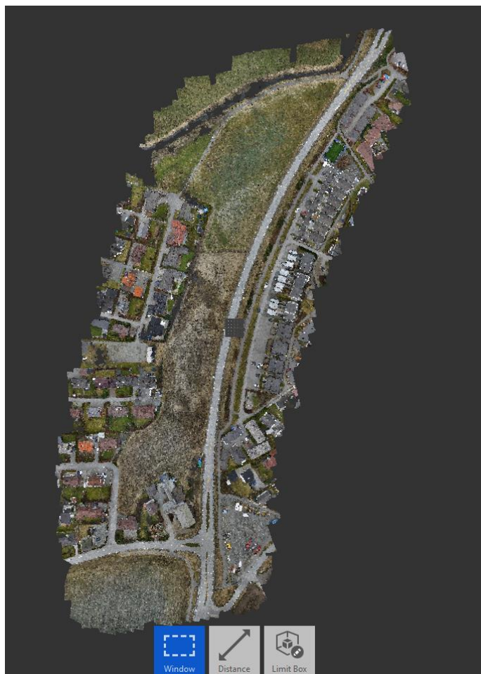
Figur 5.11 Bilde av den urenskede punktskyen importert i Autodesk Recap. Bildet viser tettheten av punktskyen som gjør at detaljer kommer tydelig til uttrykk.
