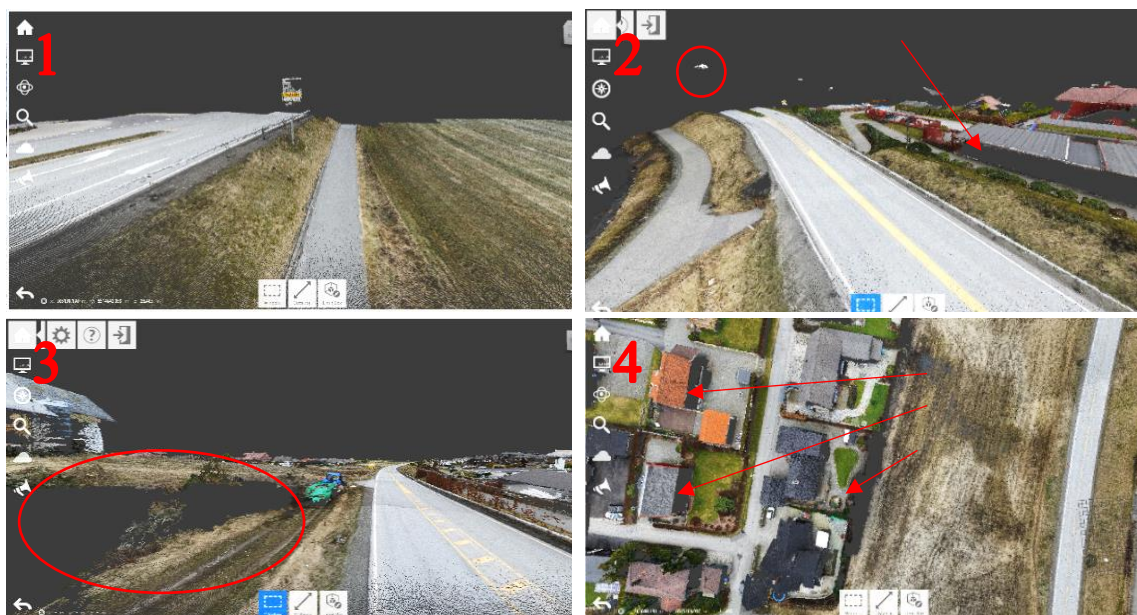
Figur 5.19 Bilder fra prosessering av den fulle modellen. Figuren peker ut elementer i modellen; noen som viser hvor detaljert modellen er, og noen som viser avvik i forhold til virkeligheten. Bilde 1 viser skilt og autovern. I bilde 2 er det et «svevende» gatelys og «svevende» tak på hus, og bilde 3 illustrerer hvordan variert vegetasjon gir hull i punktskyen. I bilde 4 er det pekt ut hvor detaljerte takene på husene er.
