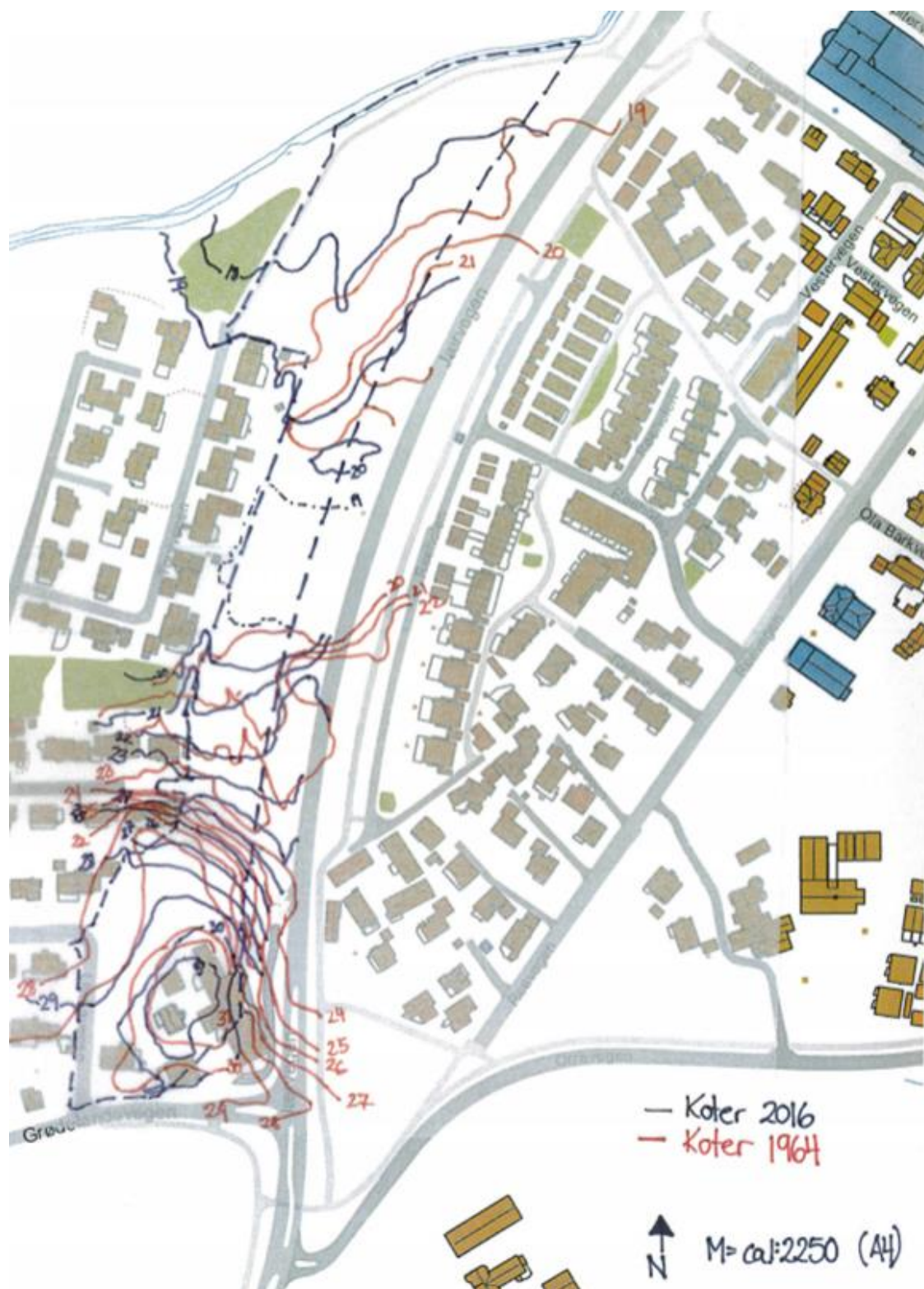
Figur 5.2 Koter i Reemarka i 1964 og 2016 (Gjengitt med tillatelse fra Prosjektil). Kartet viser at høydelinjene fra den nyeste innmålingen er avvikende fra eldre måling datert 1964. Dette eksemplifiserer poenget med å oppdatere kartgrunnlaget i forkant av prosjektering og gjennomføring av nye byggeprosjekter.
