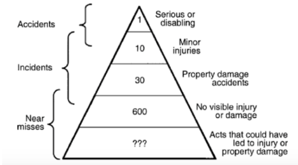
Figur 3.4 The failure types pyramid. Basert på ulykkesanalyser utført av Heinrich et al, 1980 (Hollnagel, 2004)
