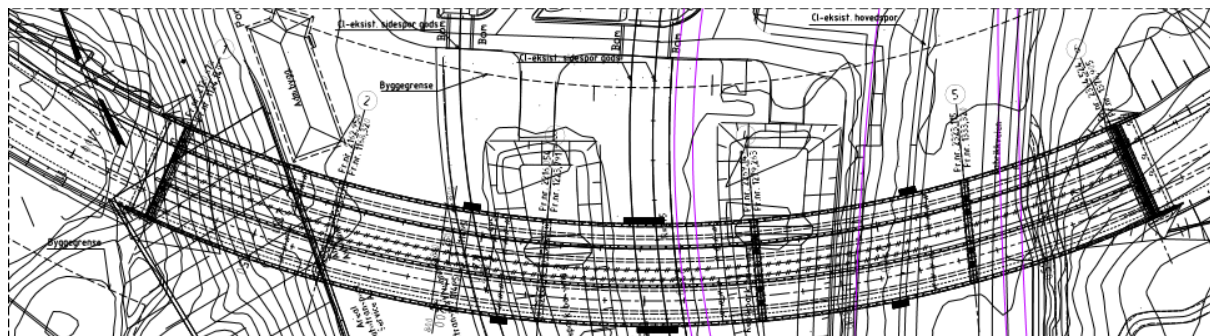
Figur 2-7 Tenkt horisontal linjeføring for Brunnholen bru. [vedlegg 1]
