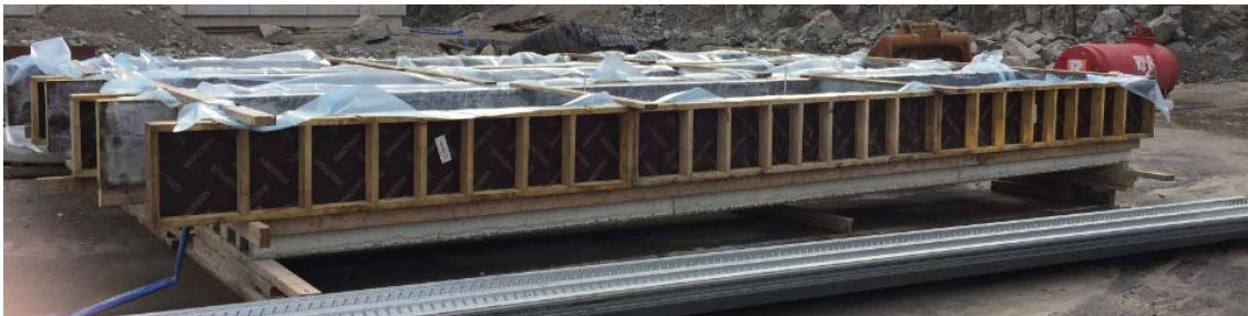
Figur 5.13: Fullskala dekketest med jevnt fordelt last
