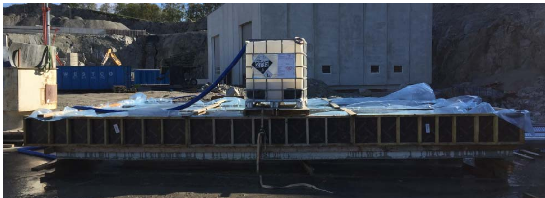
Figur 5.14: Fullskala dekketest med punktlast
