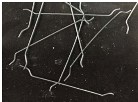
Figur 3.2: Stålfiber med endeforankring
