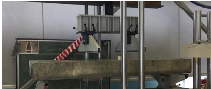
Figur 5.12: Lastrigg for dekke på 2,4 meter
