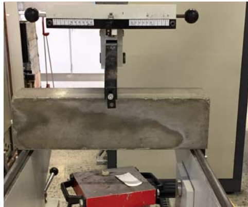
Figur 7.4: Testmaskin for bøyestrekfasthet
