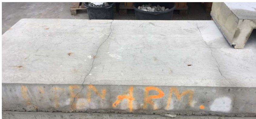
Figur 7.19: Gjennomgående riss for prøve 1-uten armering
