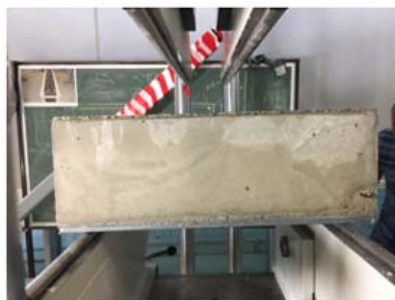
Figur 5.11: Lastrigg for dekke på 600mm
