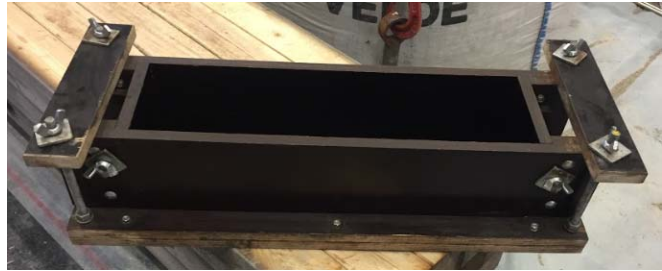
Figur 5.5: Støpeform til bjelke 150x150x550
