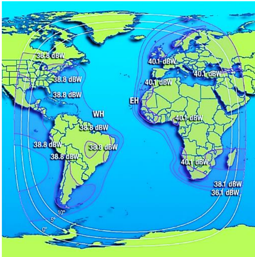
Figur 14 Dekningskart for Intelsat 905 (Intelsat, 2017)
