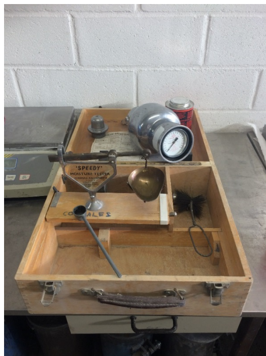
Figur 15: Måleapparat for fukt
