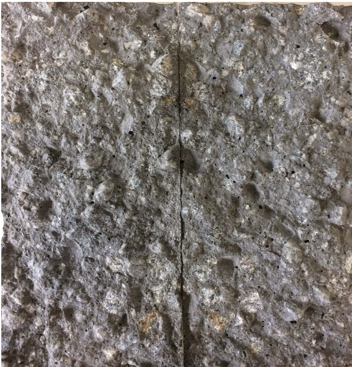
Figur 29: Snittflate av referansebetong M65
