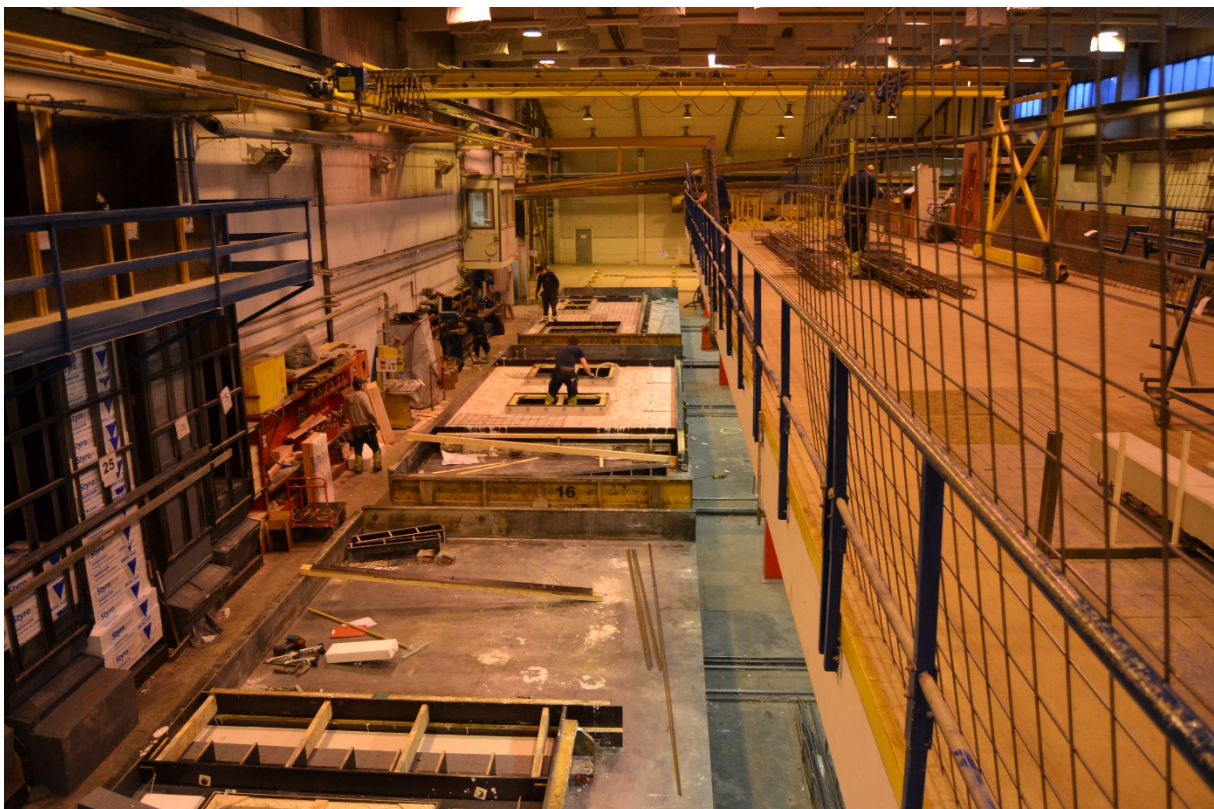
Figur 23: Produksjonslinje, Block Berge Bygg Elementfabrikk
