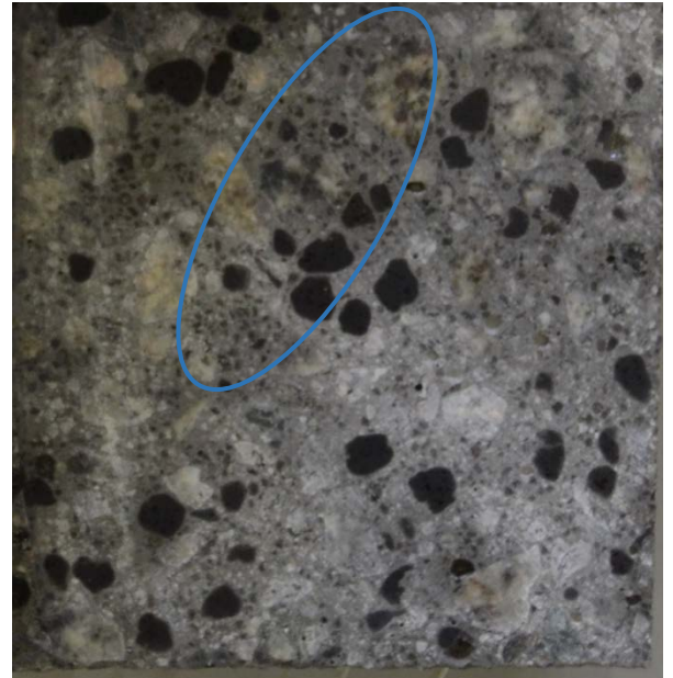
Figur 39: Snittflate av lettbetong 1850 kg/m 3
