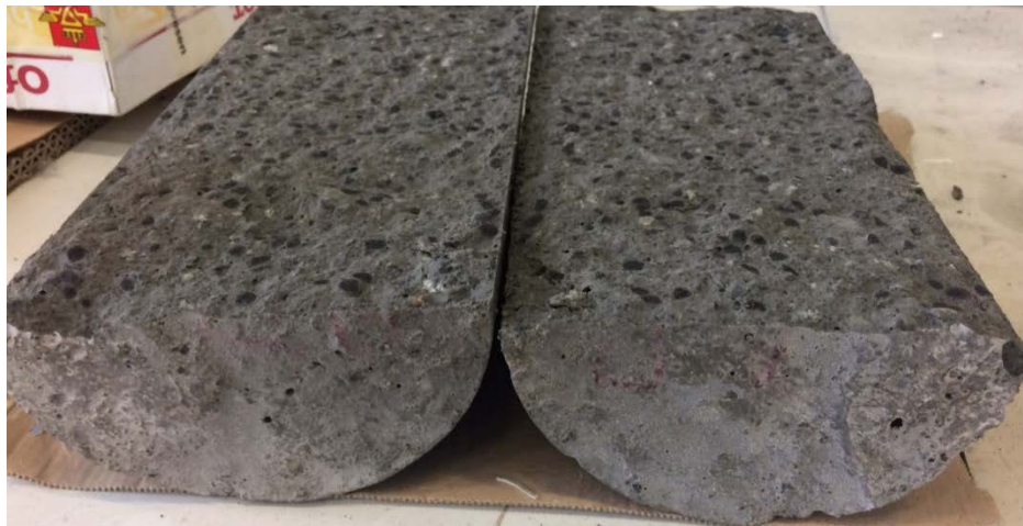
Figur 43: Snittflate av lettbetong LB40 sett fra siden
