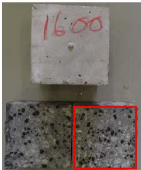
Figur 36: Kutting av lettbetong 1600 kg/m 3
