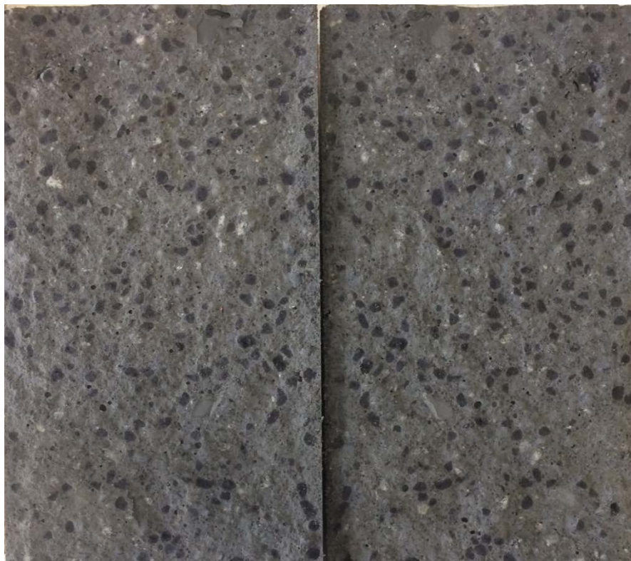
Figur 44: Snittflate av lettbetong LB40 sett ovenfra
