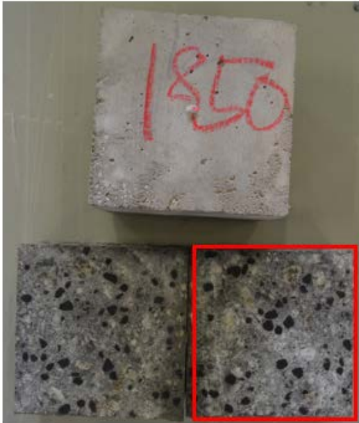
Figur 40: Kutting av lettbetong 1850 kg/m 3
