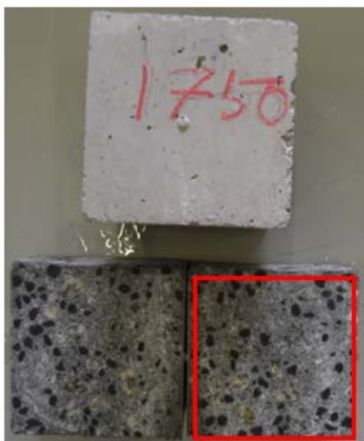
Figur 38: Kutting av lettbetong 1750 kg/m 3
