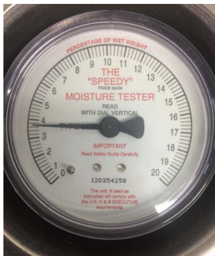
Figur 14: Speedy Moisture Tester av Velde 0/8mm
