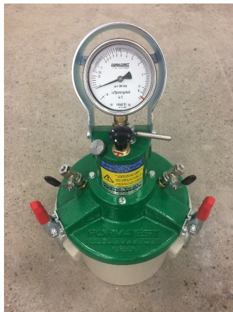
Figur 13: Måleapparat for luftinnhold
