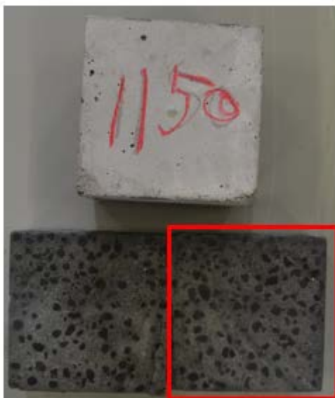
Figur 32: Kutting av lettbetong 1150 kg/m 3
