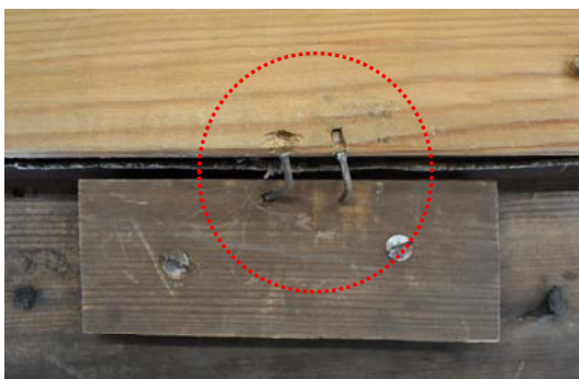
Figur 33) Utilstrekkelig montering av prydramme til maleri.
