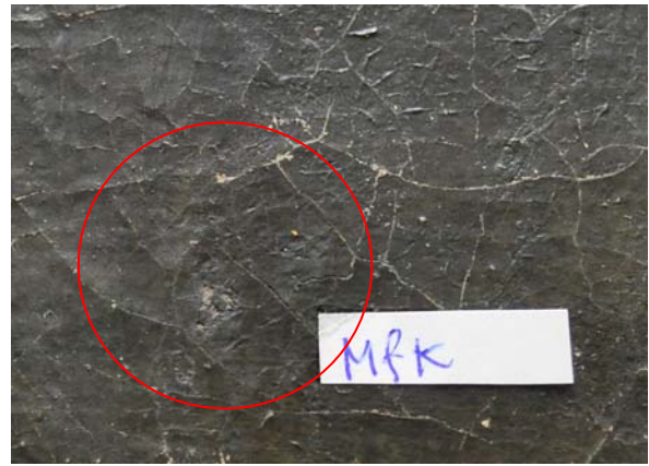
Figur 35) Samme område som i fig. 4, etter konsolidering med MfK (sidelys)
