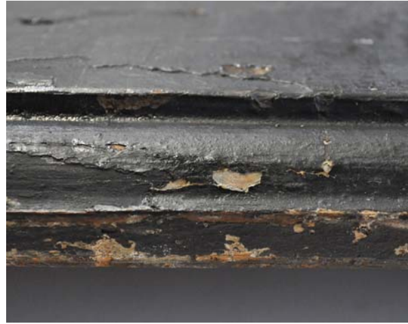
Figur 41) Samme område etter konsolidering med størlim og varmeskje
