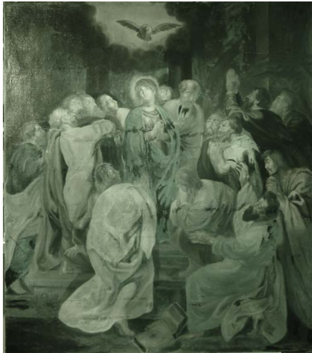
Fig.8. IR-opptak av hele maleriet. Sorte "flekker" i lyse partier er skader som ikke fremkommer i UV-lys
