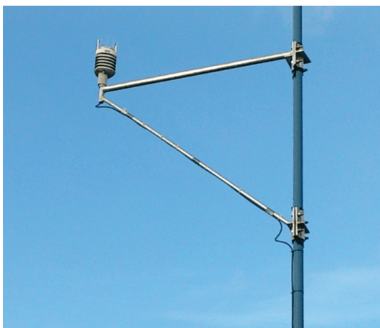
Figur 3.12 Værstasjon, type Vaisala WXT520 [12, s. 36]
